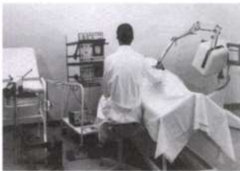
6a-b. képek. Compound scanner. A csuklóban levő potenciométerek adják az információt az elektronikának a transzducer pozíciójáról és a nyaláb irányáról. Kretztechnik. 1967
