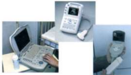
20. kép. Az extrém kis készülékek megjelenését az extrém nagyfokú integráltság teszi lehetővé. Azok a félvezetők, melyek eddig mászás készüléket igényeltek, a kis gépeknél pl. 3 integrált áramkörbe (IC) lettek beszűfolva. Persze, ha az egyikben hiba van, a készülék egyharmadát kell kidobni
